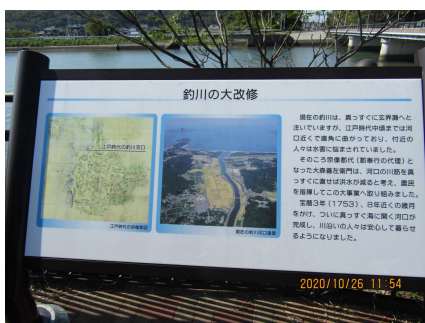
洪水の被害を無くすため、蛇行していた河川をまっすぐに!
